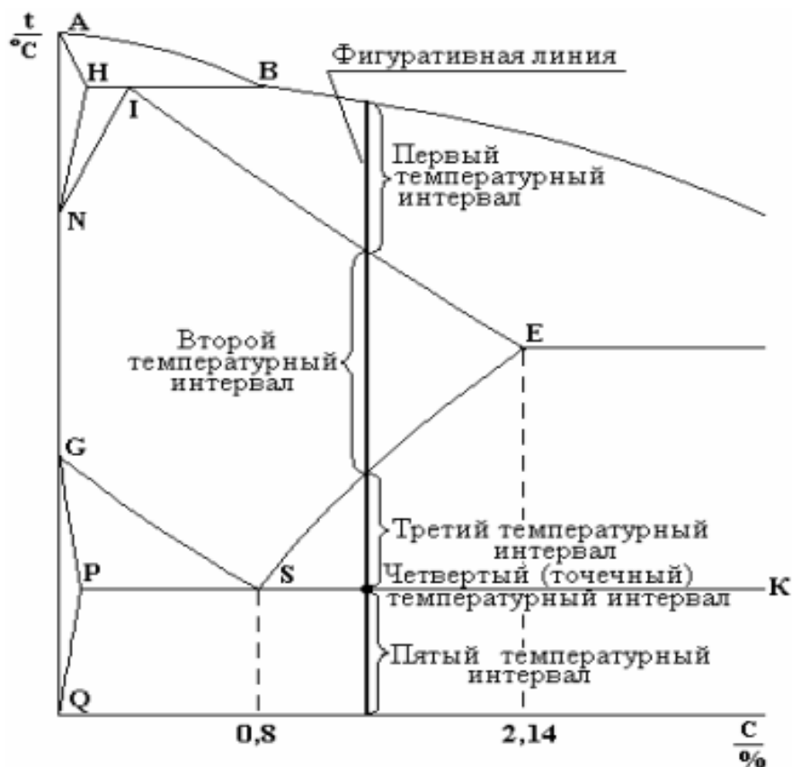
Рис. 2. Пример определения температурных интервалов фазовых превращений
